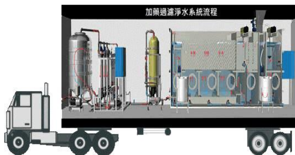
RO淨水設備
